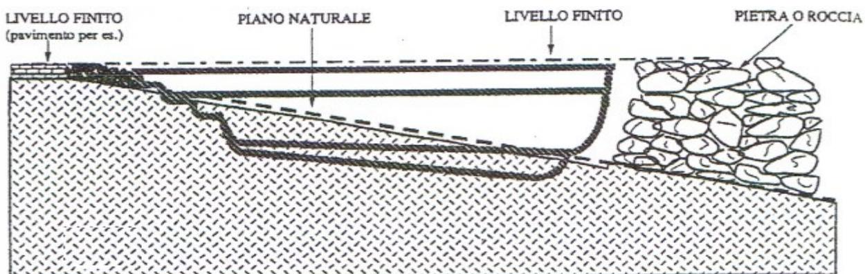
2° - Prendete come livello finito il piano più basso: E' allora necessario procedere a uno sbancamento o spianatura dello spazio prima di realizzare lo scavo .
