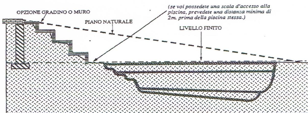
3° - Prendete come livello finito, un punto intermedio al fine di ridurre l'altezza dei lavori di compensazione.
